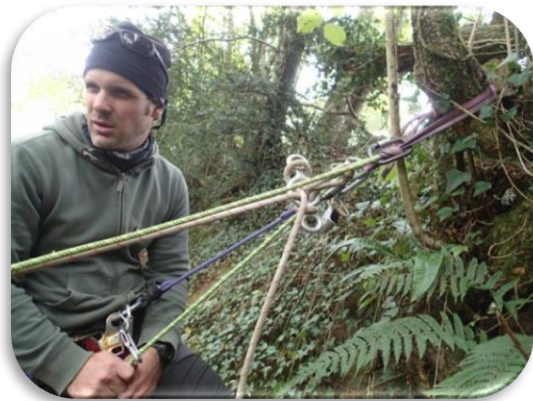
« L'utilisation de l'handy raumer pour la contrassurance et mise en place d'un double huit »
