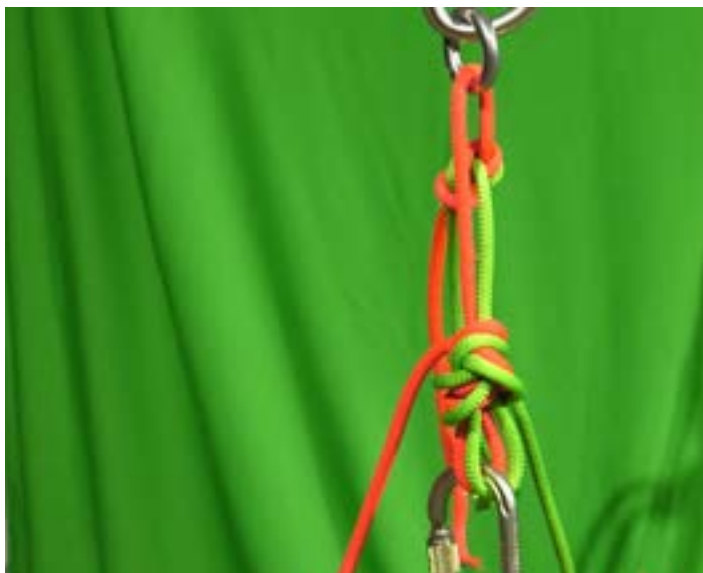
Figure 6: protocole de test de résistance des nœuds de plein poing pour le rappel avec différentes cordes. Un vérin hydraulique et un dynamomètre sont fixés au dessus du rappel. La corde à tester est fixée au sol avec un nœud de huit.
